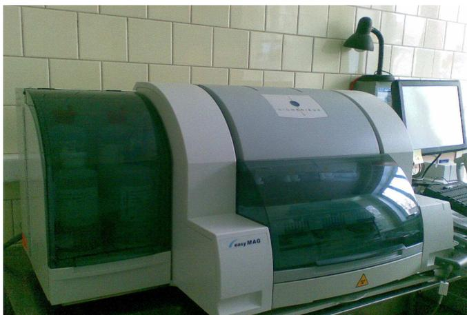
Рис. 1. Автоматическая станция для экстракции нуклеиновых кислот «NucliSENS<sup>®</sup> easyMAG<sup>™</sup>»
