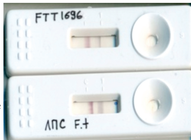
Рис. 6. Лабораторные образцы иммунохроматографических тестов для серодиагностики туляремии. 1 – тест на основе рекомбинантного белка FTT_1696; 2 – тест на основе ЛПС F. tularensis .
