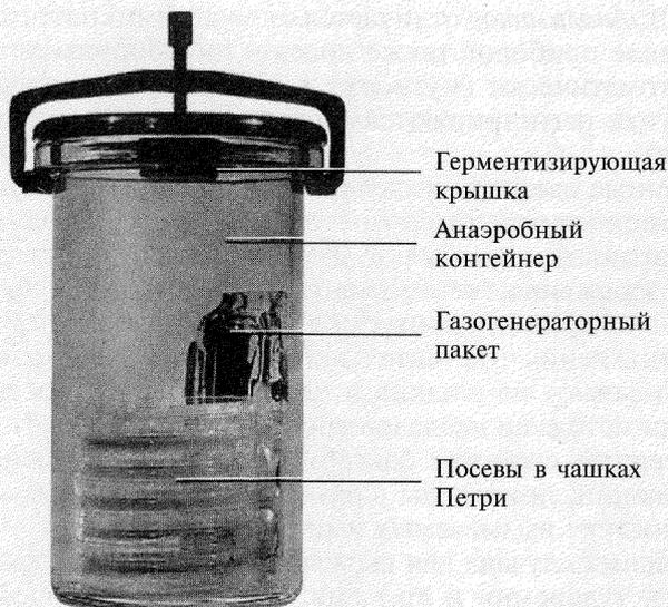
Рис. 1.7. Выращивание анаэробов в портативном анаэростате: в замкнутом объеме с помощью газогенераторного пакета создается бескислородная атмосфера
