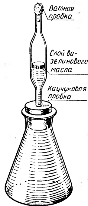
Рис. 25. Прибор для культивирования денитрифицирующих бактерий.
