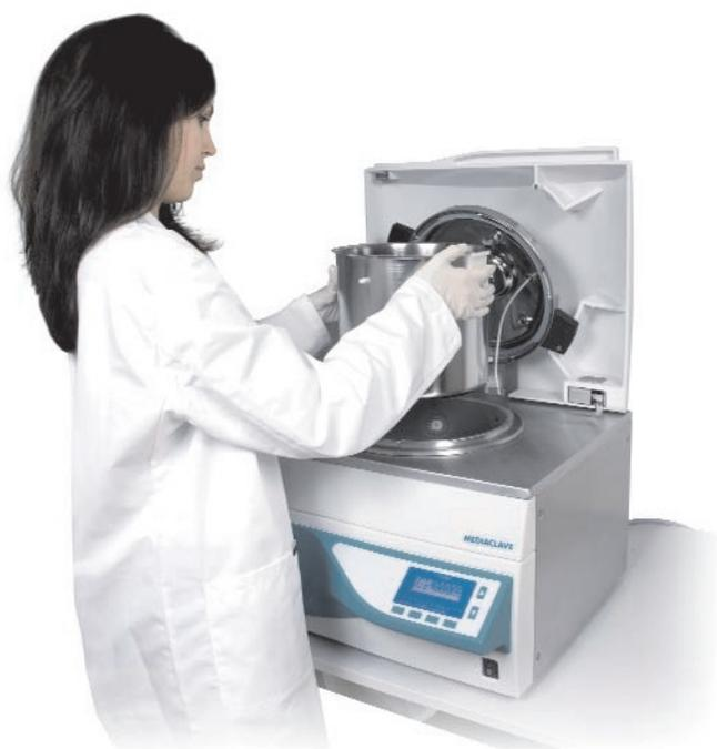
Конструкция MEDIACLAVE ориентирована на простоту обслуживания. То, что нагревательные элементы конструктивно вынесены за пределы котла, предельно упрощает его очистку.
