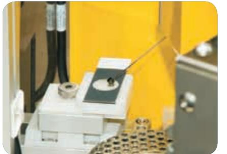
**Автоматизированная функция приготовления мазка.**
