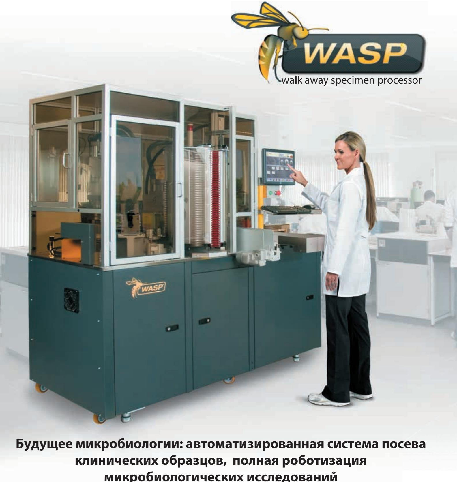
**Будущее микробиологии: автоматизированная система посева клинических образцов, полная роботизация микробиологических исследований**
