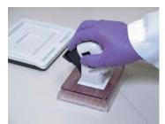
Использование 96-канального инокулятора **RENOK** позволяет приготовить стандартную суспензию и внести ее в рабочую панель одним движением в течение одной минуты.
