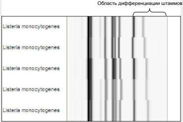
Помимо точной таксономической идентификации система RiboPrinter® надежно дифференцирует штаммы, предоставляя детальную информацию, необходимую для отслеживания контаминации и микробиологического контроля рабочего пространства.
