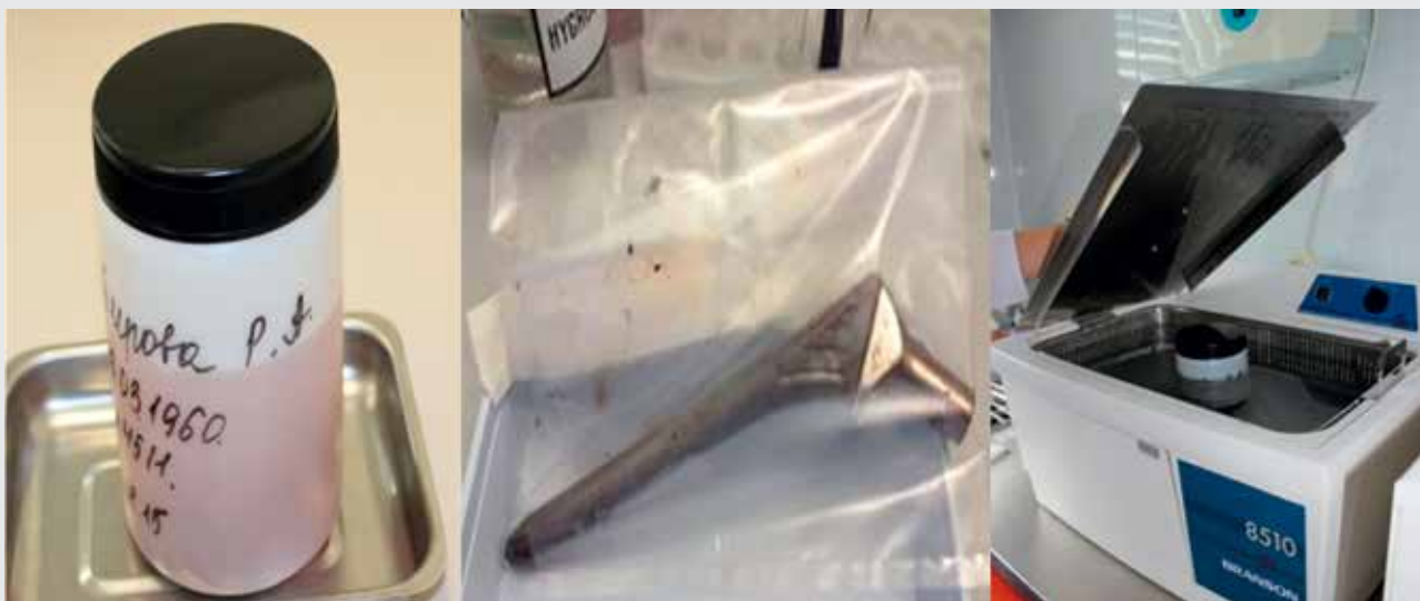
РИС. 2. Исследование удаленных компонентов имплантов с помощью ультразвуковой мойки.
