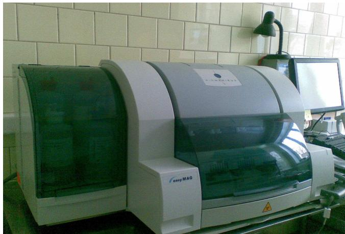
Рис. 1. Автоматическая станция для экстракции нуклеиновых кислот «NucliSENS® easyMAG™»
