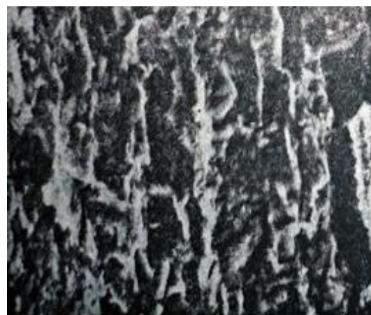
а) – зональное строение излома, развитие трещины от наружной поверхности трубы (верх рисунка), повышение шероховатости излома в средней части и участок долома (низ рисунка), X 2; б) – межзеренный, X1500; в) – внутризеренный характер роста трещины при коррозионном растрескивании X 3000
