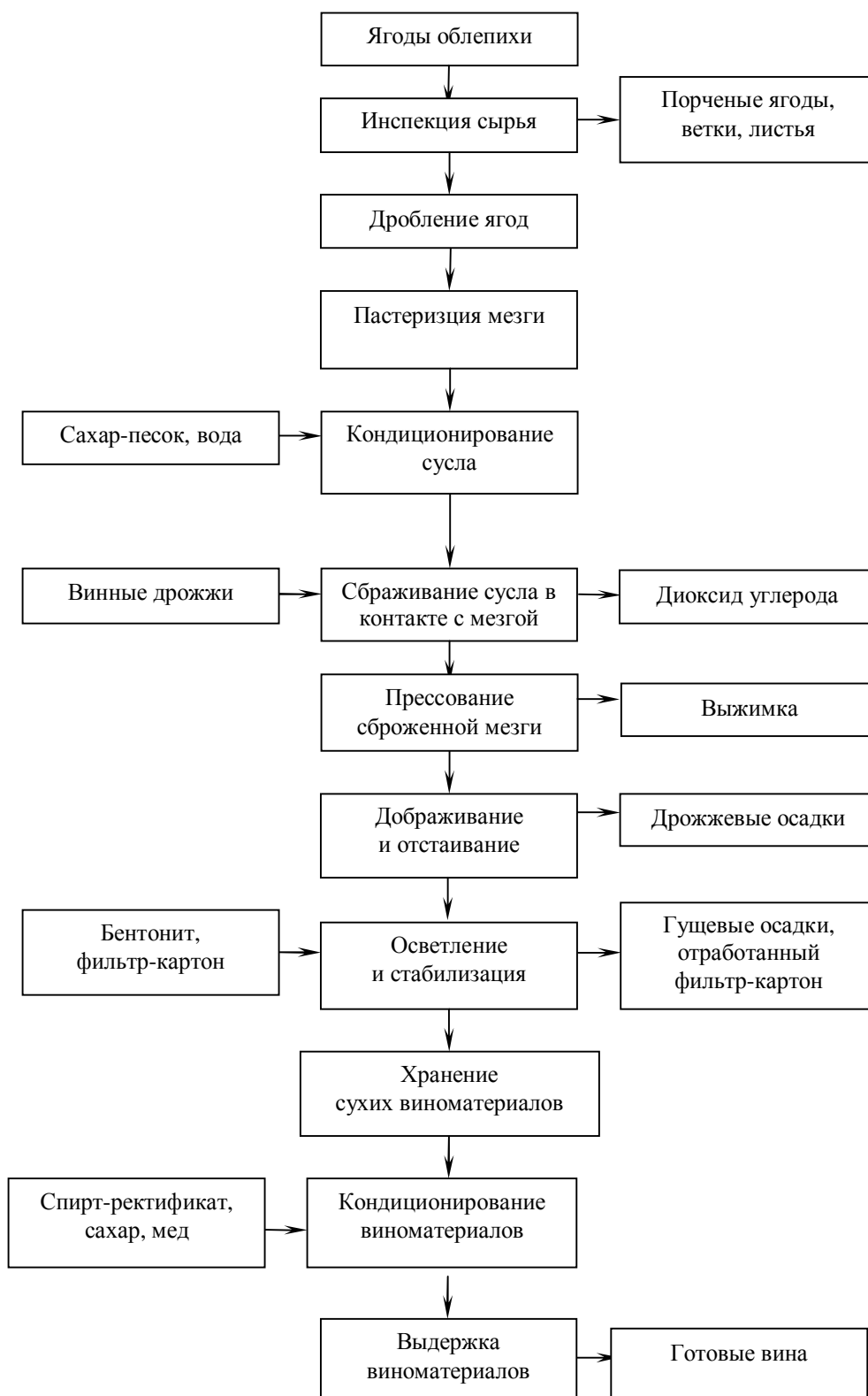
Рисунок 1 – Принципиальная схема производства вин из облепихи улучшенного качества
