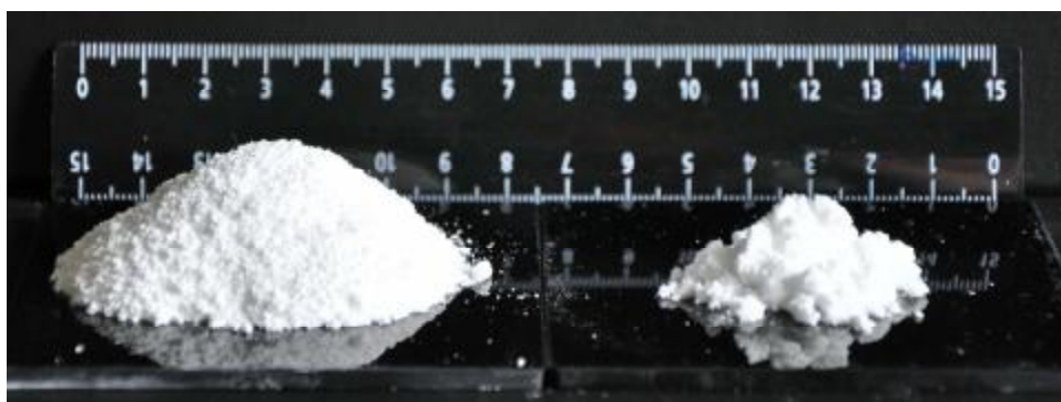
Рисунок 4 – Сравнение насыпных объемов полученного в данной работе высокодисперсного парацетамола и исходной субстанции. Навески по 1,0 г.
