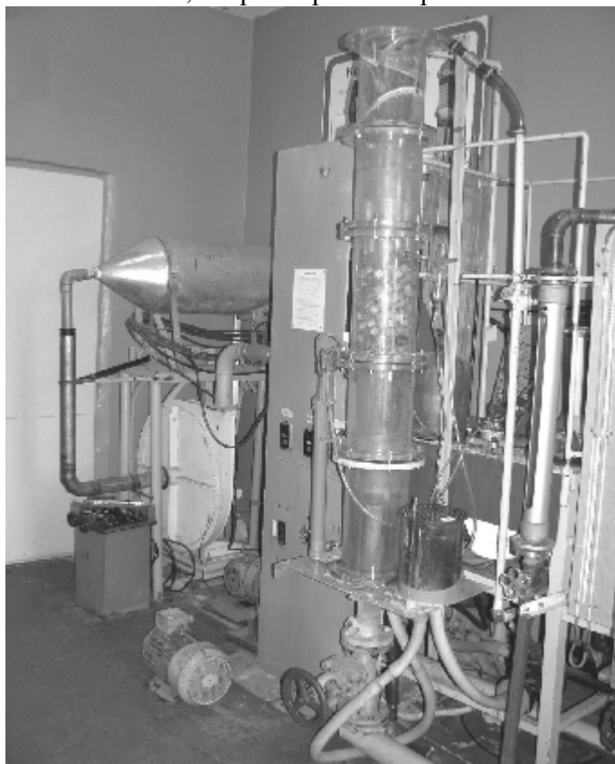
Рисунок 2 – Общий вид стенда с насадочной лабораторной колонной
