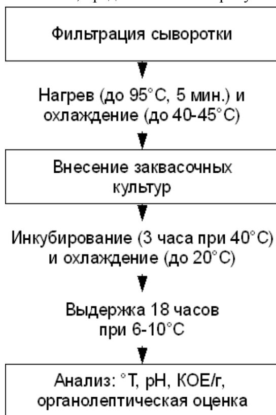
Рисунок 1 – Схема приготовления экспериментального напитка
