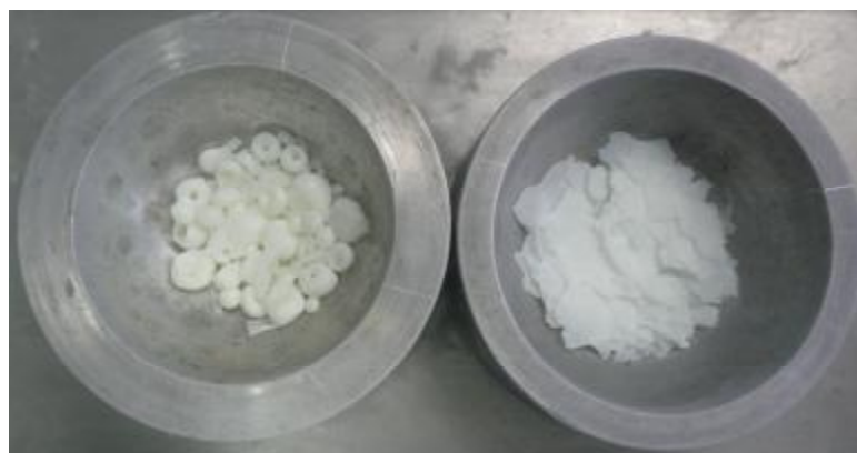
Рисунок 2 – Образцы замороженного раствора мелоксикама в диоксане: замёрзшие капли и «стеклообразная фаза» после разделения
