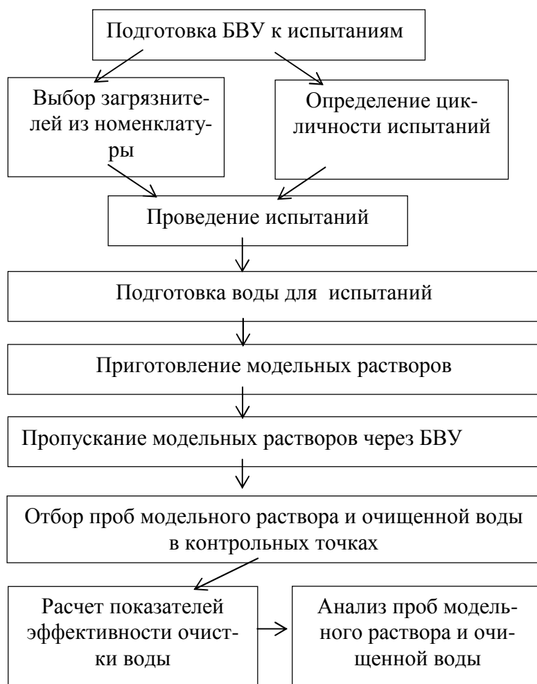
Рисунок 1 – Схема процесса оценки эффективности очистки воды БВУ
