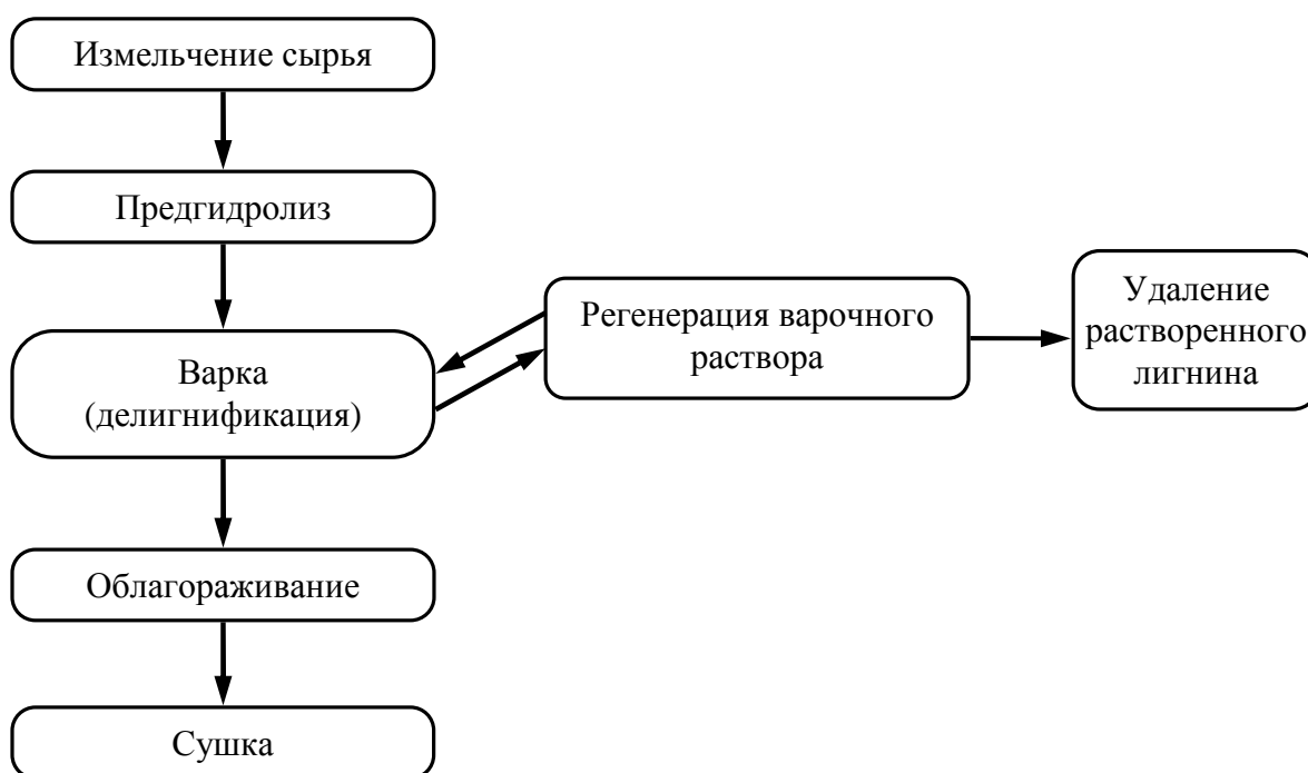
Рисунок 1 – Блок схема получения целлюлозы
