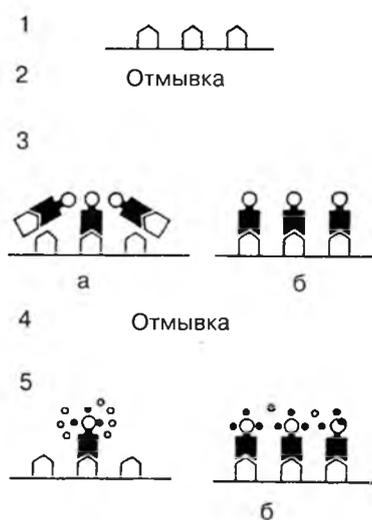
**Рис. 20.** Схема конкурентного ИФА, антиген сорбирован на твердой фазе, антитела мечены ферментом (1 — связывание АГ с твердой фазой; 2 — отмывка; 3 — инкубация меченных ферментов АТ в присутствии (а) или в отсутствие (б) исследуемой пробы; 4 — отмывка; 5 — инкубация с субстратом (светлые кружочки) и измерение количества продуктов реакции (темные кружочки))
