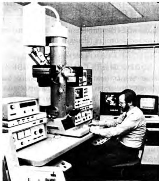
Рис. 4. Электронный микроскоп
