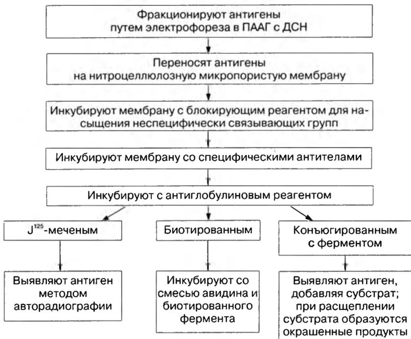
Рис. 18. Схема последовательных этапов иммуноблоттинга
