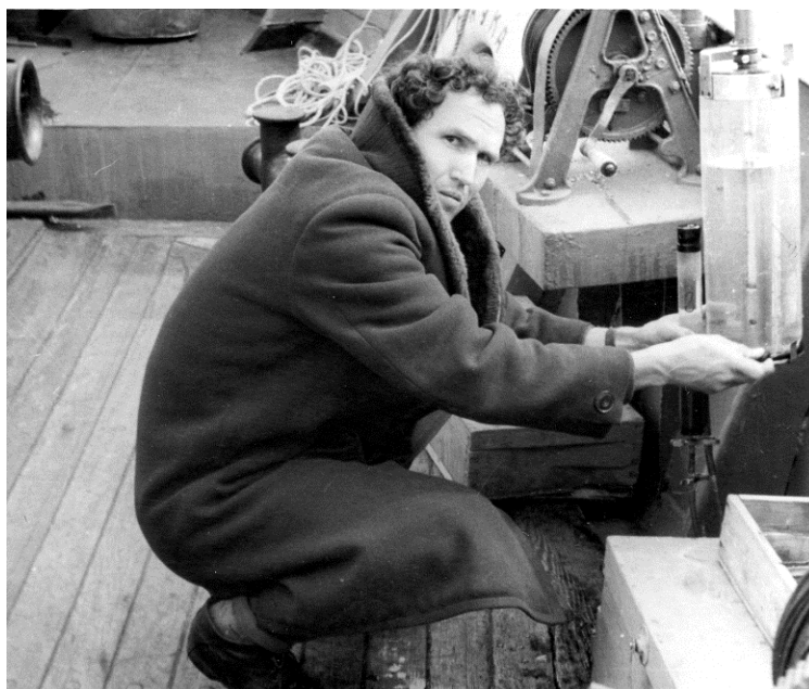
Рис. 4. Отбор проб воды на микробиологический анализ на НИС «Наука». Фото слева – И.В. Михеева, справа – А.В. Иватин
